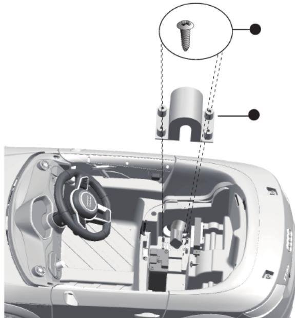
**A játékautó összeszerelésének utolsó tevékenysége a következő:** Az ülés felszerelése (helyezze be az ülést és csavarja be, húzza meg két M15X16 csavarral), rápattan a szélvédőre, a visszapillantó tükrökre, a hátsó spoilerre
