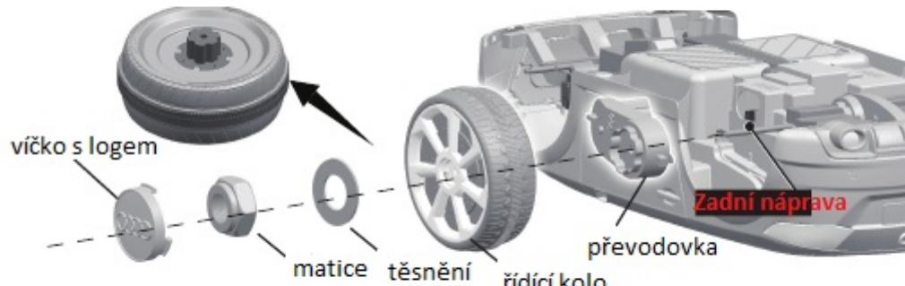
1. Prestavite menjalnik na zadnjo os. Menjalnik z oznako "R" mora biti nameščen na desni strani karoserije vozila;
