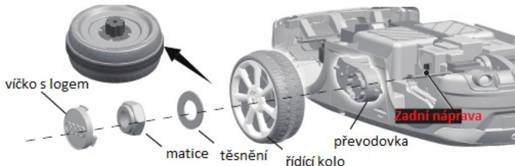
1. Gurnite mjenjač na stražnju osovinu. Mjenjač s označom "R" treba biti smješten na desnoj strani karoserije vozila;
