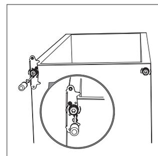
11. Vráťte dvere späť. Než definitívne dotiahnete skrutky, skontrolujte, či dvere horizontálne aj vertikálne doliehajú a či tesnenie po všetkých stranách správne dosadá.
