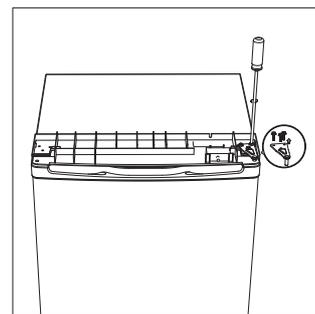
4. Odkręcić dolny zawias drzwiczek zamrażalnika. Następnie zdjąć drzwiczki, i umieścić na miękkim podłożu, żeby zapobiec ich uszkodzeniu czy zarysowaniu.
