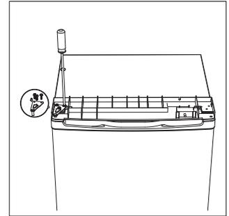
12. Założyć pokrywę i przykręcić dwie śruby z tyłu urządzenia.
