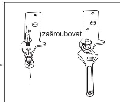
10. Instalujte konzoli na spodní závěs. Vraťte zpět obě nastavitelné nožky
