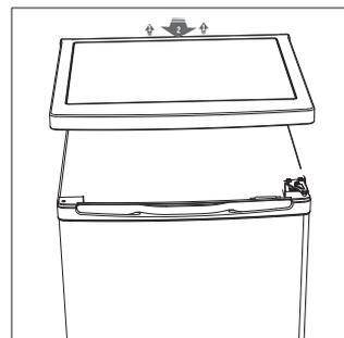
3. Odšroubujte horní závěs, odejměte dveře a položte je na měkkou podložku, aby se nepoškrábaly.
