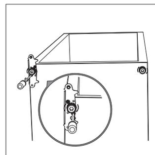
11. Vraťte dveře zpět. Než definitivně dotáhnete šrouby, zkontrolujte, zda dveře horizontálně i vertikálně líčují a zda těsnění po všech stranách správně dosedá.
