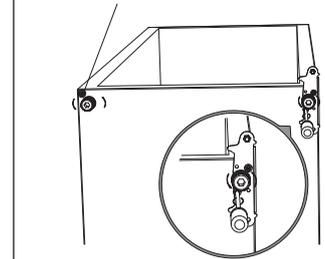
9. Odkręcić i wyjąć trzpień zawiasu dolnego, odwrócić kierunek wspornika i ponownie umieścić w nim trzpień.
