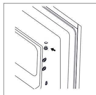
7. Obrócić drzwi zamrażalnika i umieścić zawias po lewej stronie. Następnie przymocować drzwi za pomocą uchwytu.
