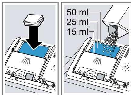
Pokud používáte tablety, stačí jedna tableta. Tablety vkládejte napříč. Pokud používáte práškový nebo tekutý mycí prostředek, dodržujte pokyny k dávkování výrobce a návod k dávkování zásobníku mycího prostředku.
