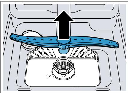
3. Pod tekoucí vodou zkontrolujte, zda nejsou ucpané výstupní trysky ostříkovacích ramen a popř. odstraňte cizí tělesa.
