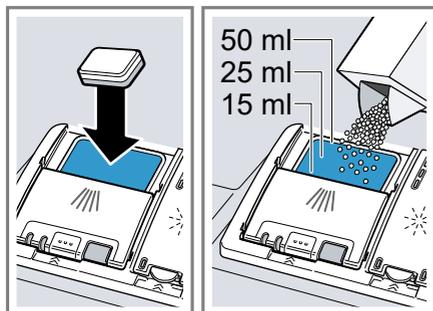
Pokud používáte tablety, stačí jedna tableta. Tablety vkládejte napříč. Pokud používáte práškový nebo tekutý mycí prostředek, dodržujte pokyny k dávkování výrobce a návod k dávkování zásobníku mycího prostředku.
