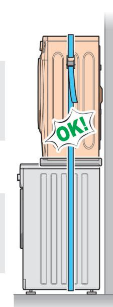
IT Una volta posizionata l'asciugatrice, tendete bene la cinghia per stabilizzare la colonna. Verificate periodicamente la tensione della cinghia e la stabilità dell'assemblaggio. Il posizionamento dei cavi degli elettrodomestici, deve seguire la regolamentazione elettrico - tecnica. Non sottoporre a torsione, schiacciamento e taglio i cavi. Tenere lontano dalla portata dei bambini. Utilizzare sotto la diretta supervisione di un adulto competente.
